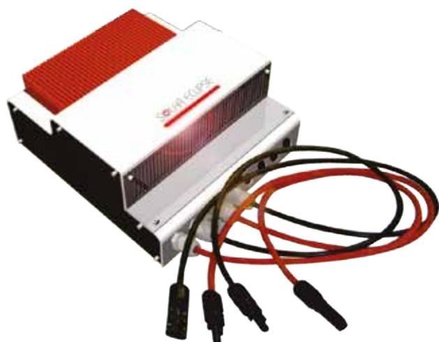
Solar Eclipse è un sistema intelligente che accumula l'energia elettrica prodotta in eccesso dall'impianto fotovoltaico, per poi utilizzarla quando occorre. Viene collegato ad un pacco batteria a 48 V e all'impianto esistente, tra i moduli fotovoltaici e l'inverter connesso alla rete. Compatibile con tutti gli inverter fotovoltaici con MPPT tradizionale, è certificato CEI 0-21 per impianti monofase e trifase.
