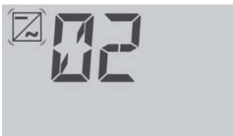
Fig.: LCD: Numero di inverter riconosciuti
