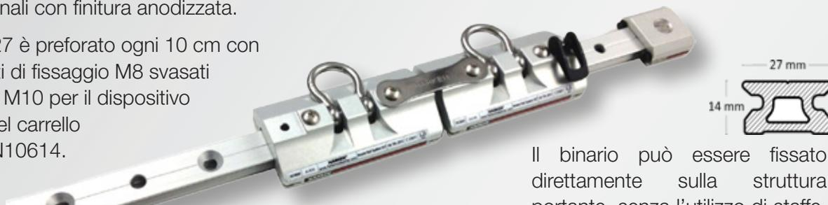
Il binario può essere fissato direttamente sulla struttura portante, senza l'utilizzo di staffe, utilizzando ancoraggi idonei al materiale della struttura stessa. L'interasse tra i fissaggi dovrà essere pari a 10cm, 20cm o al massimo 30cm, da valutare in base alla struttura portante.
