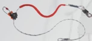
**DISPOSITIVO ANTICADUTA RETRATTILE**, lunghezza cavo variabile. Certificato anche per utilizzo orizzontale/inclinato se utilizzato in abbinamento al cordino art.5030101. Cavo in acciaio zincato d.4 mm, carico di rottura 12 kN. Dotato di assorbitore di energia integrato e connettore girevole. Carter di protezione in ABS.
