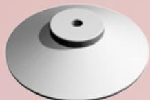
Coppella in alluminio, elemento optional di completamento degli ancoraggi strutturali di estremità ed intermedi tipo palo. Inserito in testa al palo assicura lo smaltimento delle acque meteoriche battenti che vengono così allontanate dalla base del palo, diminuendo il rischio infiltrazione al fine di preservare l'integrità della struttura di supporto.
