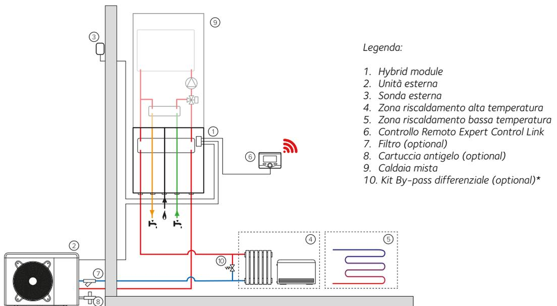
\* By-pass regolabile da installare nel caso di impianti con valvole termostatiche su tutti i terminali o valvole di zona, al fine di garantire la minima portata di funzionamento.
