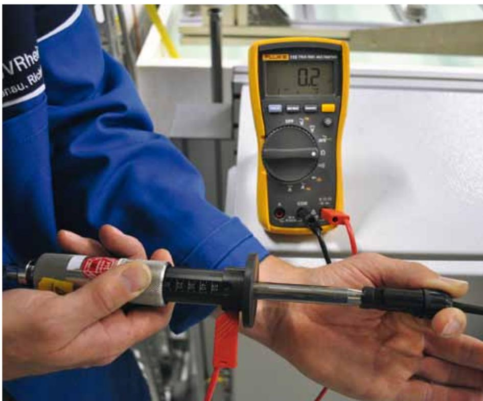
In due dei cinque moduli sottoposti al test, provenienti da produttori cinesi (che hanno deciso di non essere nominati), i contatti del connettore maschio possono essere toccati con il dito di prova. Un vero tabù!
