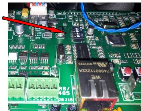
Figura 9 – Dip-Switch di configurazione
