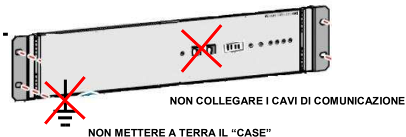
Figura 2 – Cablaggi batterie PylonTech
