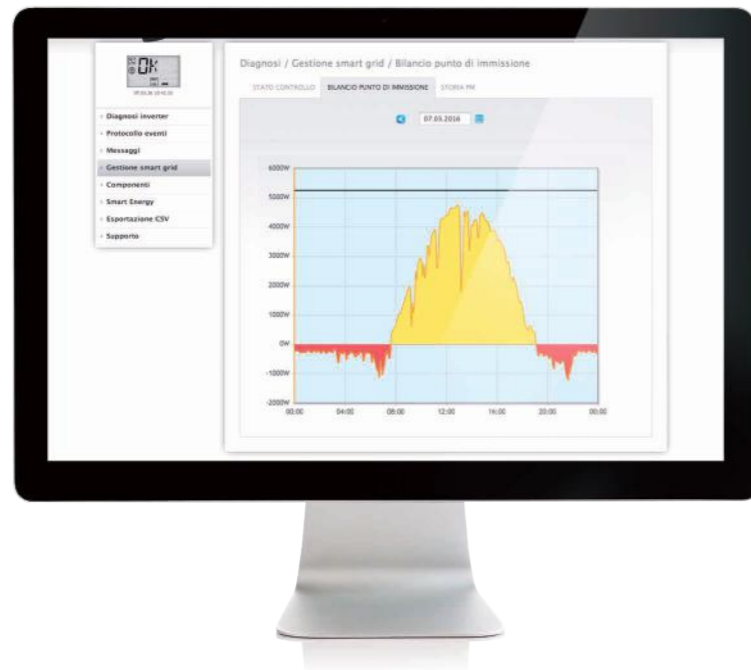
Gestione Feed-In - Bilancio al punto di immissione : Questo diagramma mostra a colpo d'occhio orario e somma della potenza immessa in rete, nonché orario e somma della potenza prelevata dalla rete. I valori negativi (rosso) rappresentano il prelievo dalla rete e i valori positivi (giallo) rappresentano l'immissione in rete.
