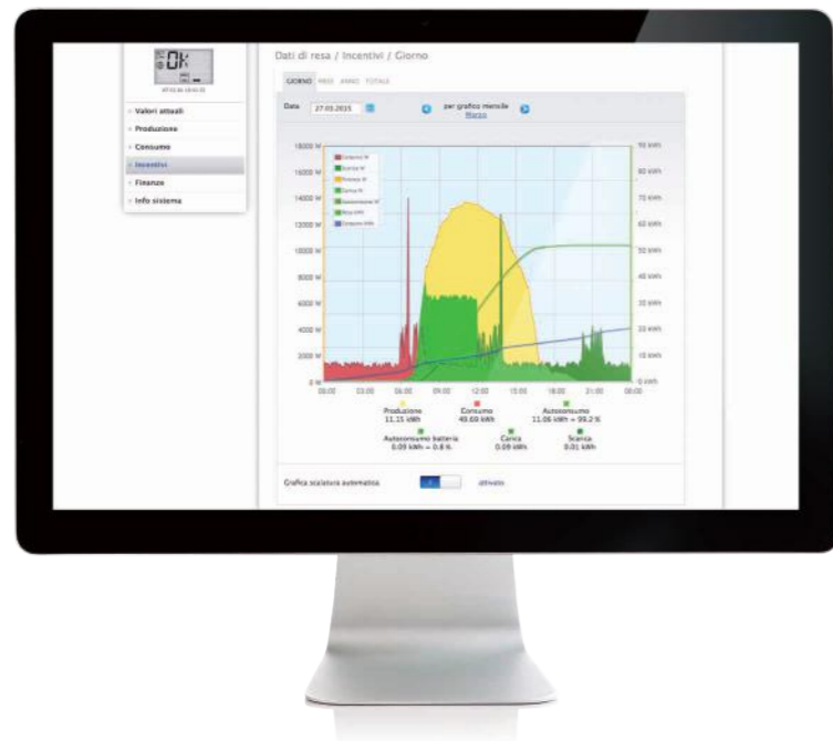
Sintesi giornaliera: la batteria viene ricaricata dalla produzione eccedente dell'impianto fotovoltaico (verde chiaro) e in caso di necessità scaricata (verde scuro) per evitare il prelievo di energia dalla rete.
