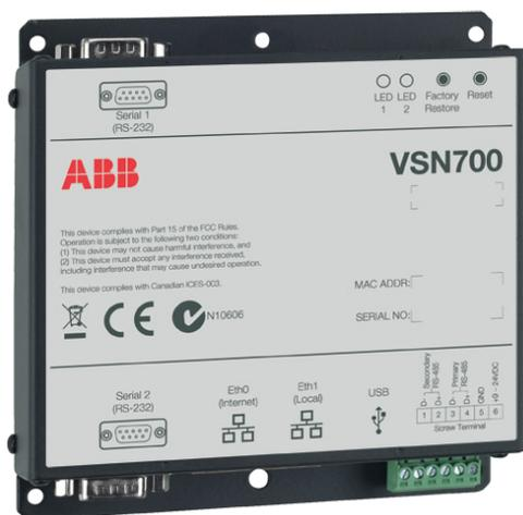
Il VSN700 Data Logger è un data logger dalle elevate prestazioni che, grazie alla funzione di rilevamento automatico dei dispositivi e degli indirizzi IP, unita alla presenza di funzione per la gestione remota, garantisce un'installazione semplice ed immediata.
