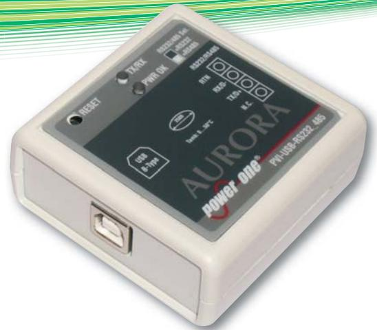
Il convertitore di segnale **PVI-USB-RS485\_232** è l'accessorio di accesso alla gamma dei prodotti per il monitoraggio degli inverter **Power One Aurora**. Il **PVI-USB-RS485\_232** basa la sua funzionalità su un microprocessore FTDI FT232RQ USB compatibile con lo standard USB2.0. La varietà di driver disponibili, rende il prodotto utilizzabile con i più comuni sistemi operativi\*.
