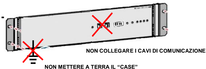
Figura 2 – Cablaggi batterie PylonTech
