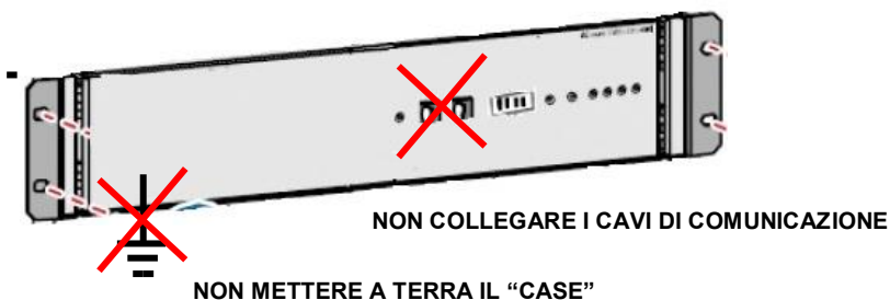
Figura 2 – Cablaggi batterie PylonTech
