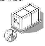
**3.2.4** No stacking the modules at the project site. 禁止在项目地将组件堆码。
